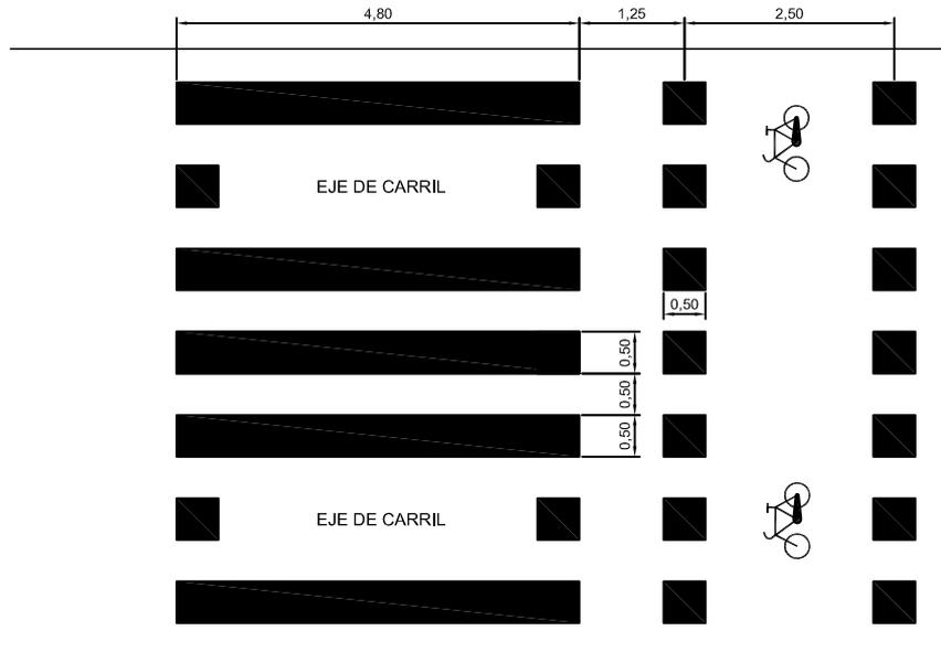
La señalización horizontal en símbolos, flechas y pasos de peatones, se realizará con pintura de larga duración, con plásticos en frío, de dos componentes, el resto con pintura acrílica convencional, tipo especial ciudad, todo ello conforme a la 8.2 I.C. sobre "Marcas viales" del Ministerio de Fomento.
