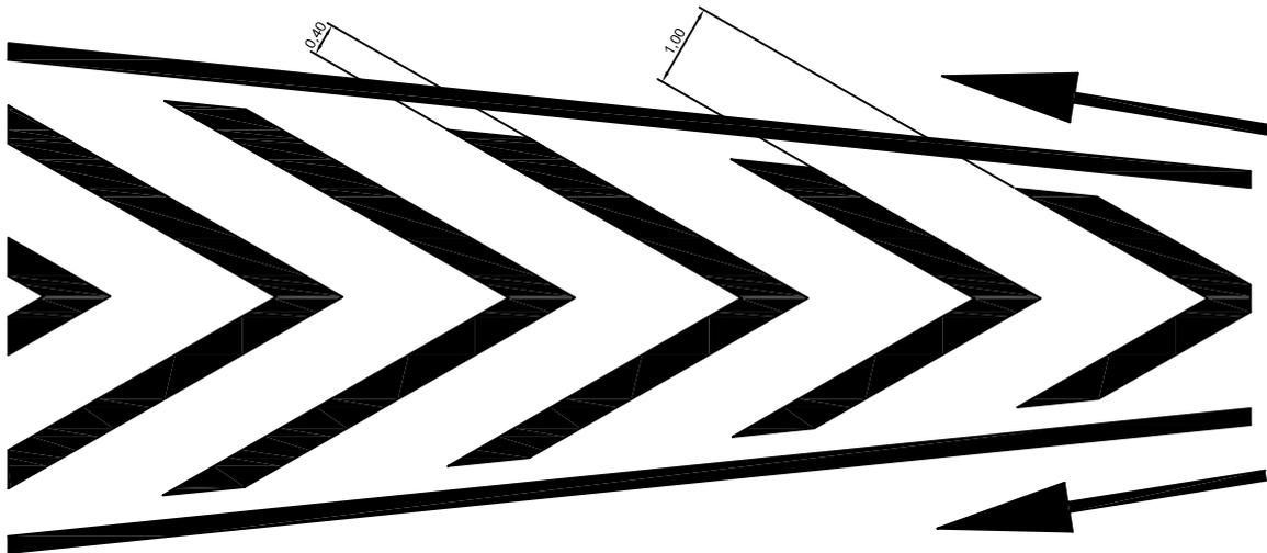
La señalización horizontal en símbolos, flechas y pasos de peatones, se realizará con pintura de larga duración, con plásticos en frío, de dos componentes, el resto con pintura acrílica convencional, tipo especial ciudad, todo ello conforme a la 8.2 I.C. sobre " Marcas viales" del Ministerio de Fomento.
