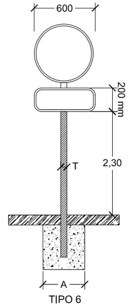
\*Postes de sustentacion de aluminio anodizado estriado Ø minimo 76 mm e=5mm
